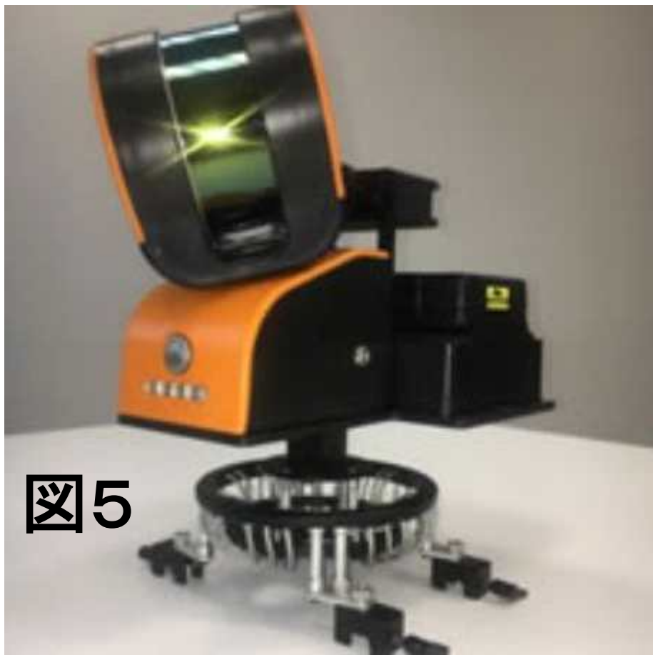
図5: マウントキットにスキャナーとデータロガーを取り付けた写真。
