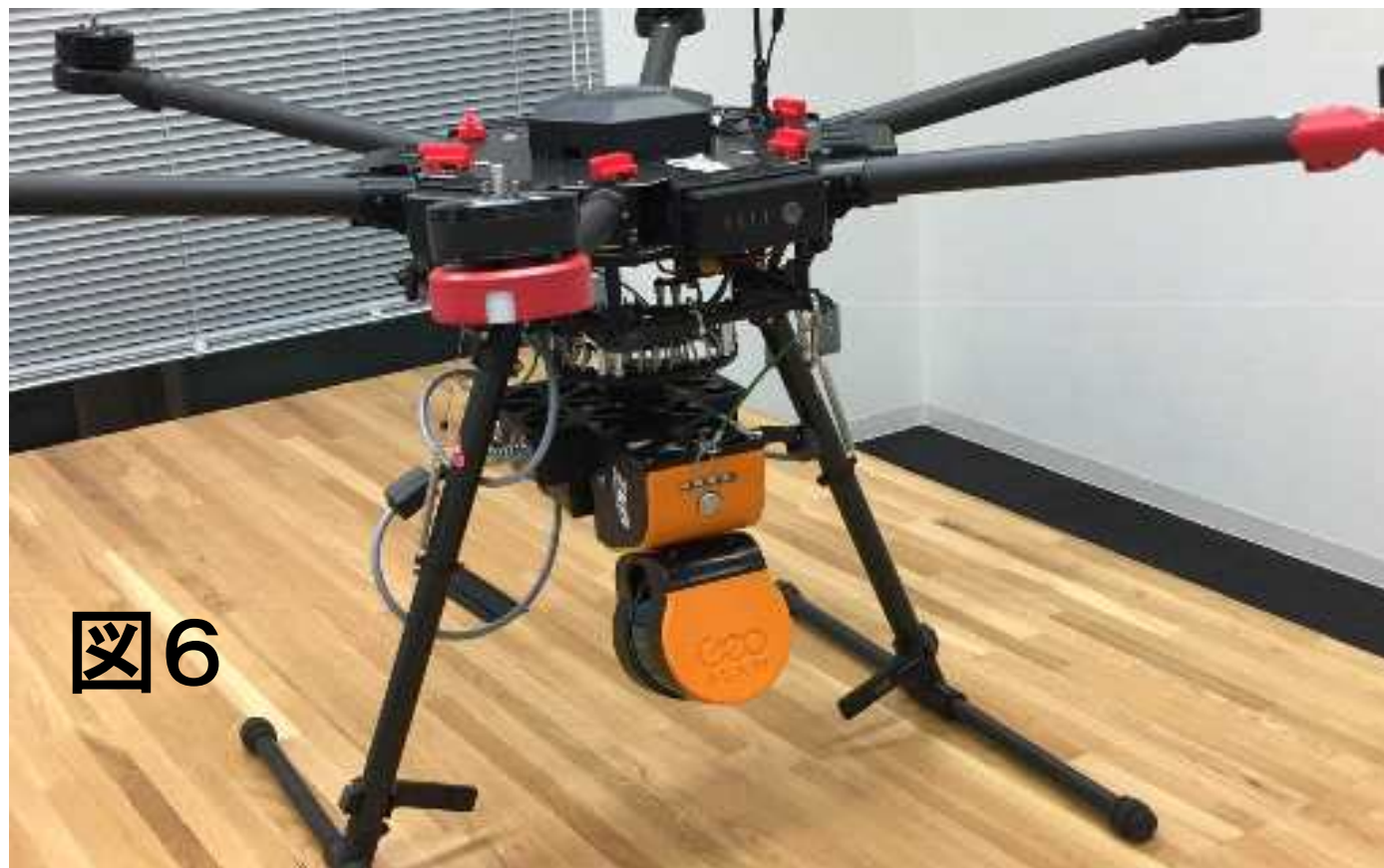
図6: M600に、マウントキットを使ってスキャナーとデータロガーを取り付けた写真。
